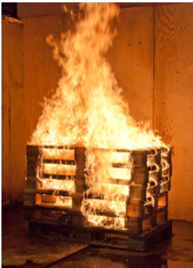
Figur 9 Pallestabelen er fullstendig overtent. Varmeutviklingen ligger på ca. 1 megawatt. Foto: Thor Kr. Adolfsen
