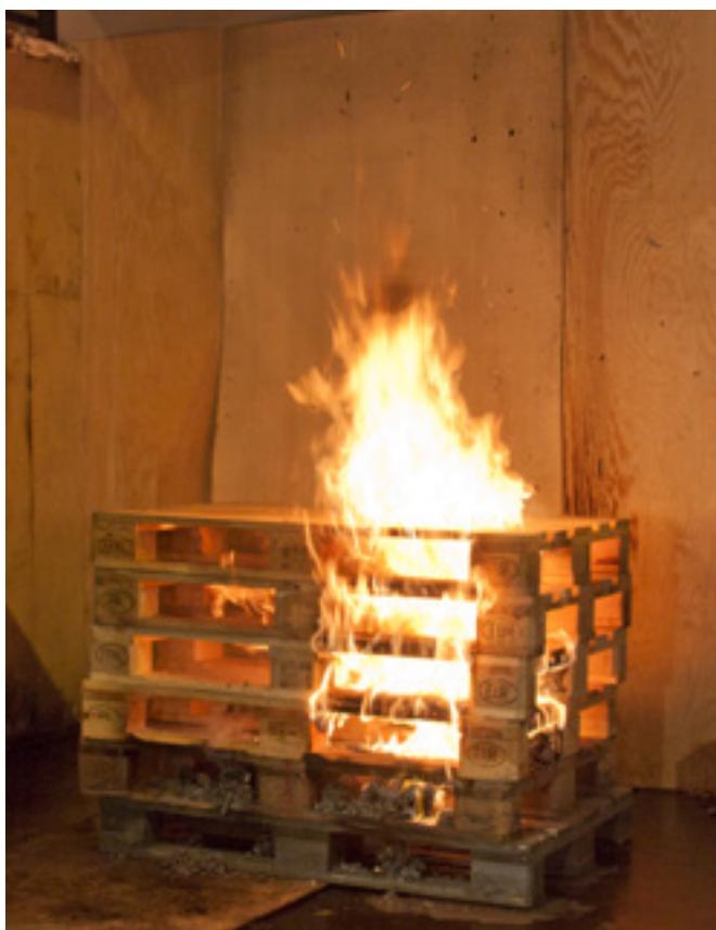
Figur 8 Det er nå gått seks og en halvt minutt fra antennelse. Varmeutviklingen er så stor at en tilfeldig forbigående antakelig vil vegre seg for å prøve å slokke med f.eks. et håndslukkeapparat. Foto: Thor Kr. Adolfsen
