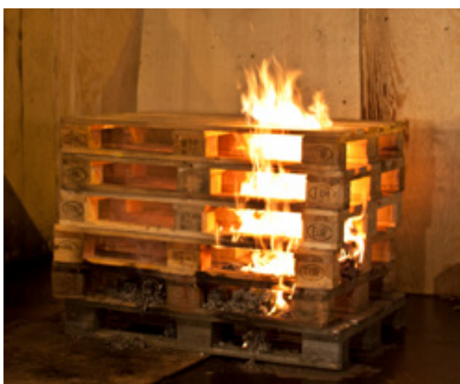
Figur 7: Det er nå gått seks minutter fra antennelse. Hvor lang tid det tar med antennelse av papir til dette stadige kan variere mye. Variasjonen kan skyldes mengde papir og hvordan det er lagt inn i stabelen. Fuktigheten i palle materiale og trekk kan også bety en del. Foto: Thor Kr. Adolfsen
