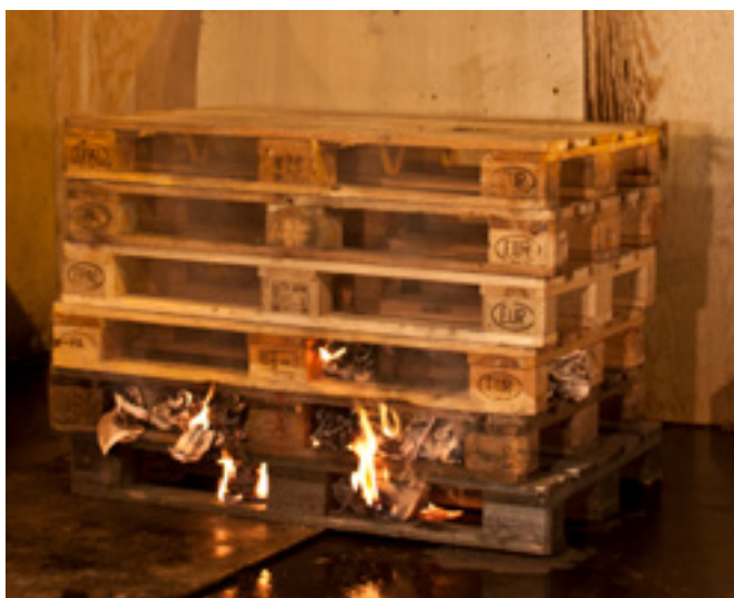
Figur 6: En pallestabel på seks paller antennes med aviser. Det utvikles relativt lite røyk og varmeutviklingen er beskjedent. Under hele forsøket måles varmeutvikling og røykutvikling. Foto: Thor Kr. Adolfsen
